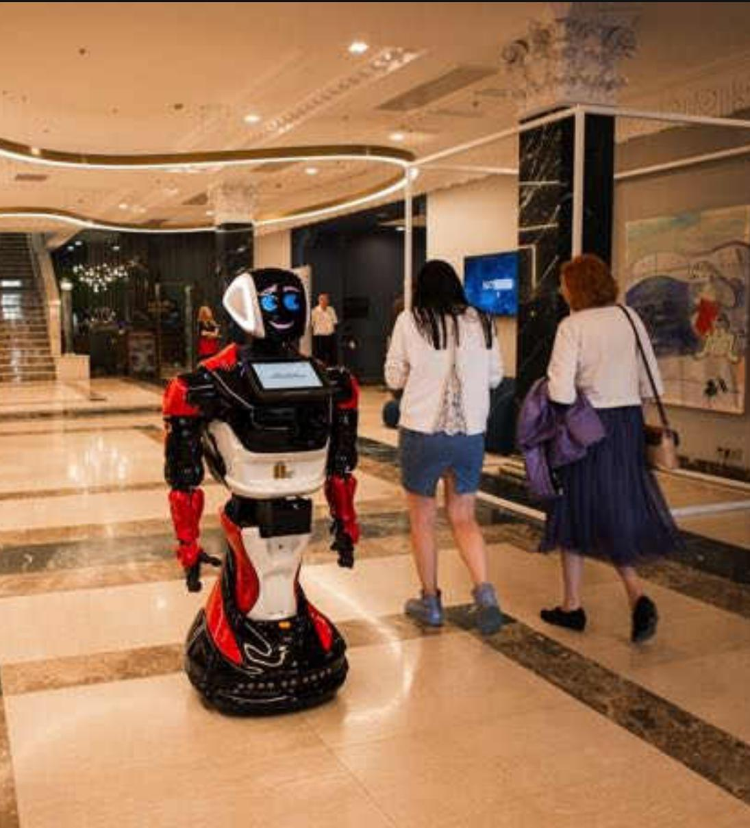
**Робот, который предназначен заботиться о посетителях, отвечать на вопросы и следить за безопасностью.**
